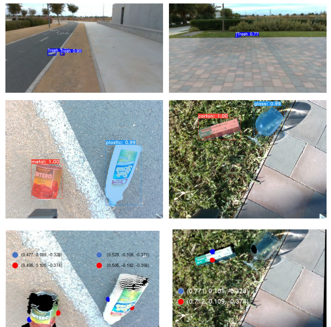
Figura 10: Localización y navegación (arriba), detección y clasificación (en medio) y estimación de puntos de agarre en residuos (abajo)
